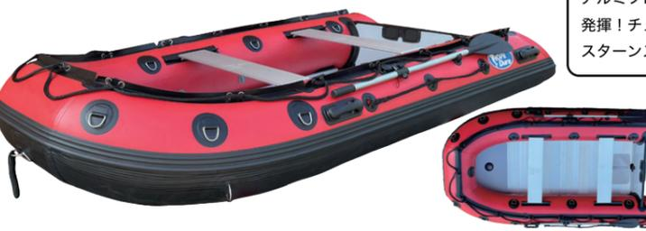
アルミフロアを採用することでボートの剛性を上げ、低重心化させることで、安定した走行性を発揮！チューブボトムガードにより、ガレキなどの浮遊物がある中でも救助活動に出勤可能に！スターンステップコーンを搭載しているため、後方からの救助をより安全に行うことを可能に！
