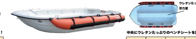
2馬力使用時、定員5人! カタマラン船型採用! 抜群の静止安定性!
