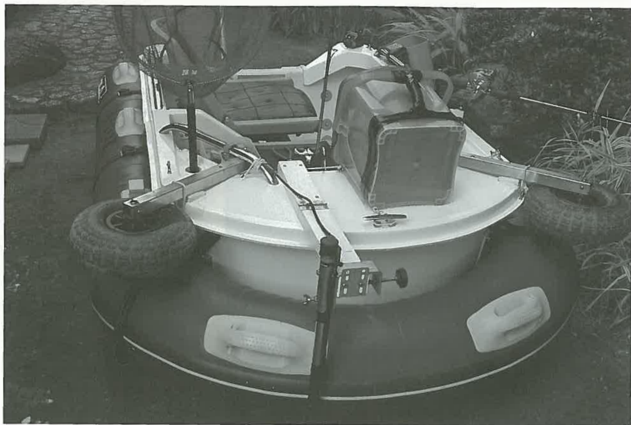
ボートを前から見たところです。折り畳み式アームを伸ばした送受波器の状態と魚探の位置、及びドーリーのパウデッキ先端への積載状態が分かればと思います。ドーリーの固定方法は、舷側のアイストラップにロープの小さな輪を付けて、これにドーリーの脚を通した後、サイドレールの下に差し込んで固定しています
