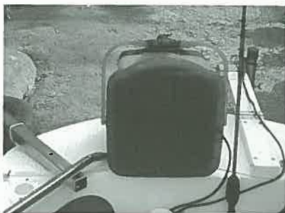
魚探です。カー用品店で見つけた踏み台バケツを、横置きに使いました。写真左はフタをした写真右はフタを外したところです。写真右の奥にバッテリーと接続線類がはいつています。魚探の下の台は、発泡スチロール製レンガ(100円ショップで購入)で、魚探を固定するのにぴったりでした
