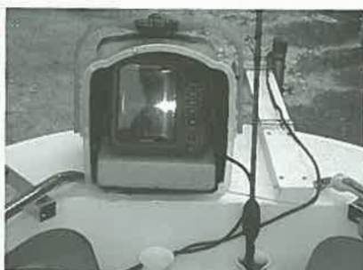
魚探です。カー用品店で見つけた踏み台バケツを、横置きに使いました。写真左はフタをした写真右はフタを外したところです。写真右の奥にバッテリーと接続線類がはいつています。魚探の下の台は、発泡スチロール製レンガ(100円ショップで購入)で、魚探を固定するのにぴったりでした
