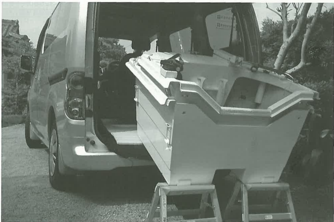
小型三脚(千円程度)2台を使って、愛車(ニッサンNV200)に載せます。車内の2、3列目はシートを外しています。宣伝のつもりはありませんが、この車はホイール間隔が広く床が低いので、ミニボート積載にはまことに具合がよく、積載車を思案中のかたにはご検討をおすすめします
