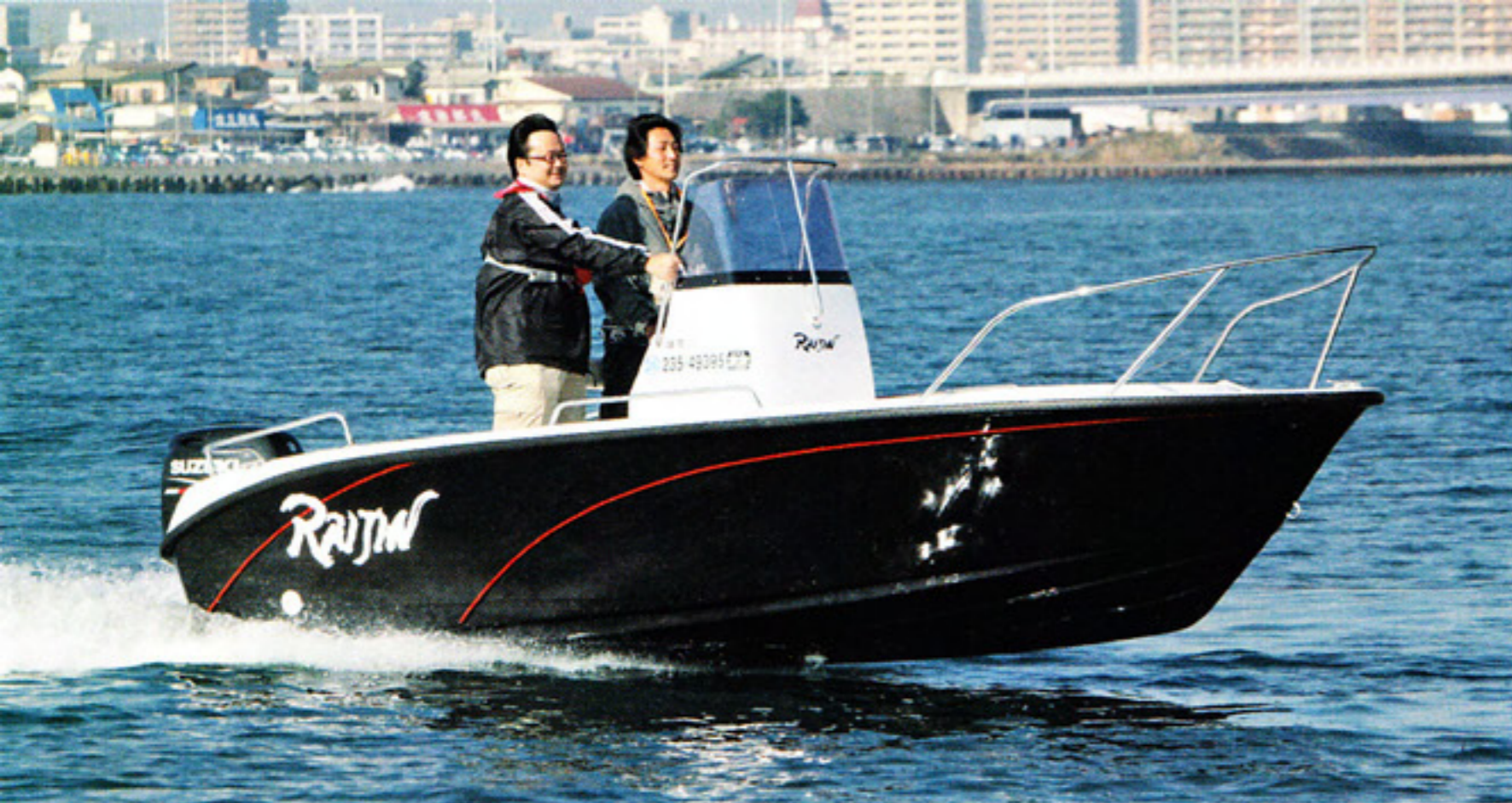
乾舷を高くし、安全性も重視したデザインを採用している。大きめのコンソールには2人が並んでいられるように、ステアリングを左舷にオフセットしている。パウとスターンのレールはオプション
