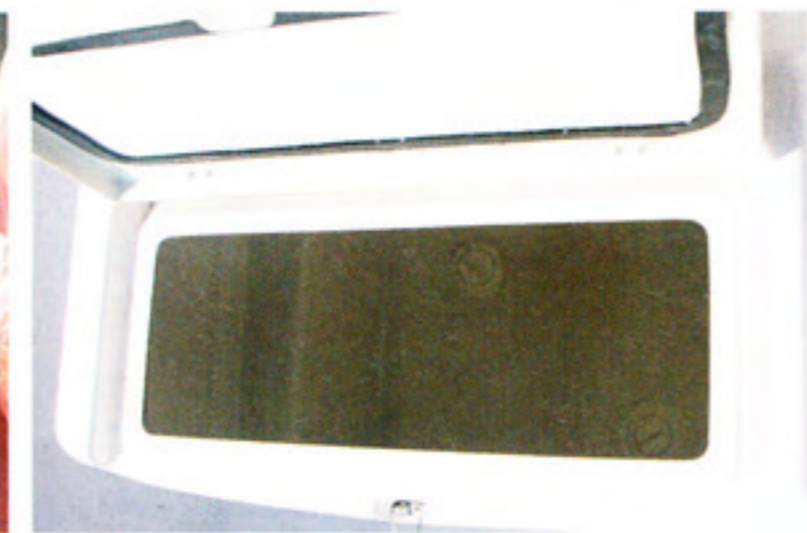
(上左)ボックス型シート内は二重構造になっており、スノコを外すと床下の収納スペースが現れる。ふだん使用しないものを収納しておける (上右)コンソール前のシート内部はイケース。かなりの容量があるため、使用しないときは水を抜いて閉じておいたほうがよい (左)スターンのストレージには、左舷側に携行型燃料タンク、右舷側にバッテリーが収まる。メインバッテリーのほかにサブバッテリーも設置可能だ。ストレージの上面は座るのに十分な面積がある
